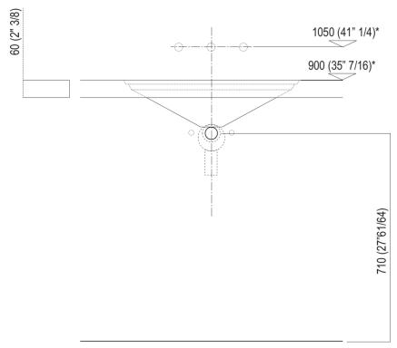
Scarico per sifone ad incasso e piletta con canotto fisso Drain for concealed waste trap with not adjustable pipe
